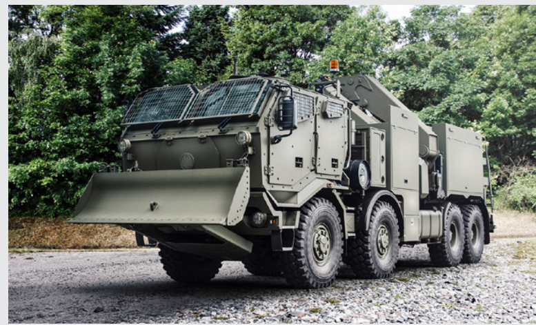
Pancéřovaná kabina. Nejnovější vyprošťovací vůz na podvozku Tatra Force 8x8 vznikl podle požadavků Armády České republiky a je vybaven prodlouženou pancéřovanou kabinou.
