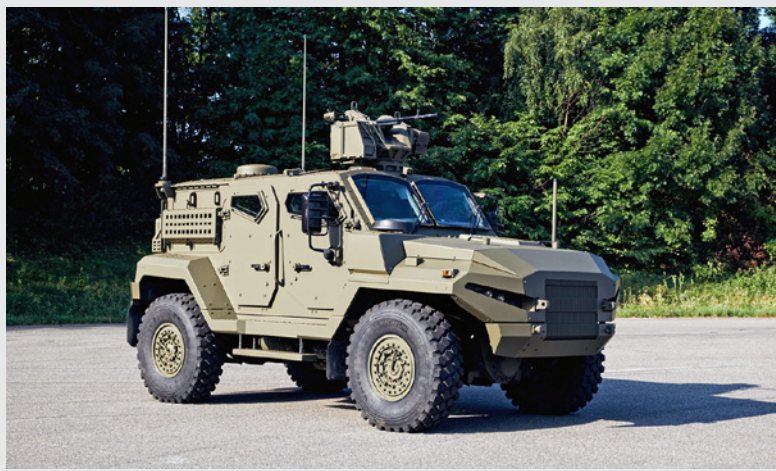
Novinka na Eurosatory 2018. Obrněné vozidlo Patriot 4x4 Tactical APC využívá unikátní podvozky Tatra s centrální nosnou rourou a výkyvnými polonápravami.
